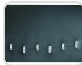
*Трехболтовые соединения очень длинные и должны устанавливаться поперек продольного разрыва. Два болта крепятся к свободно свешивающейся стороне разрыва ленты.*
